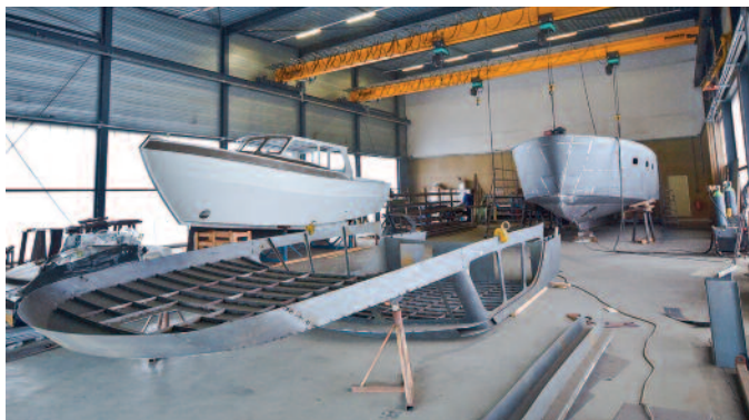
Stahlbau vom Feinsten. In der mit Fußbodenheizung ausgestatteten Kaskohalle herrscht stets gleichbleibendes Klima, sodass der speziell vorbehandelte Stahl weder Rost ansetzt, noch sich „verziehen“ kann.
