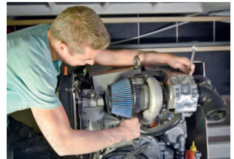
Motoreninstallation in das fertige Kasko.
