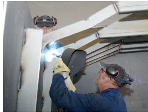
Spanten aus acht Millimeter starkem Stahl werden passgenau eingeschweißt.
