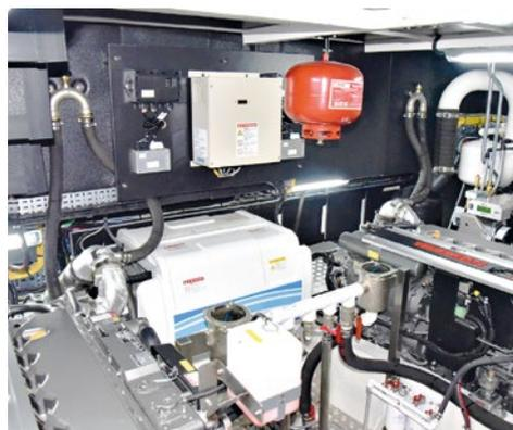
Ein Maschinenraum, der das Techniker-Herz höher schlagen lässt. Hier verrichten die beiden Sechszylinder-Dieselmotoren vom Typ „6LY440“, á 324 kW (440 PS), ihren Dienst.
