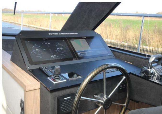
**Modernste Elektronik am aufgeräumten Steuerstand. Zwei große Flatscreens ersetzen sämtliche Einzelinstrumente für die sichere Schiffsführung, Bug- und Heckstrahl-Joystick, Ruder und die Zweihelbschaltung – mehr braucht's nicht.**
